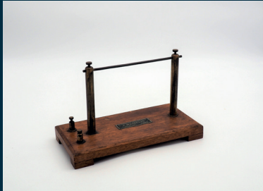
Expérience d'Oersted, Collection INSPE Université Caen Normandie et illustration pédagogique (source Aseiste)
